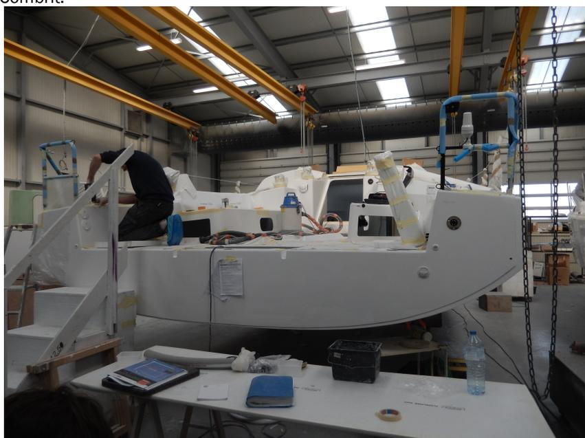
Coque en phase finition et pose des pièces d'accastillage.
